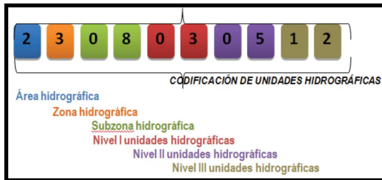
Figura 22. Estructura básica para la codificación de cuencas
